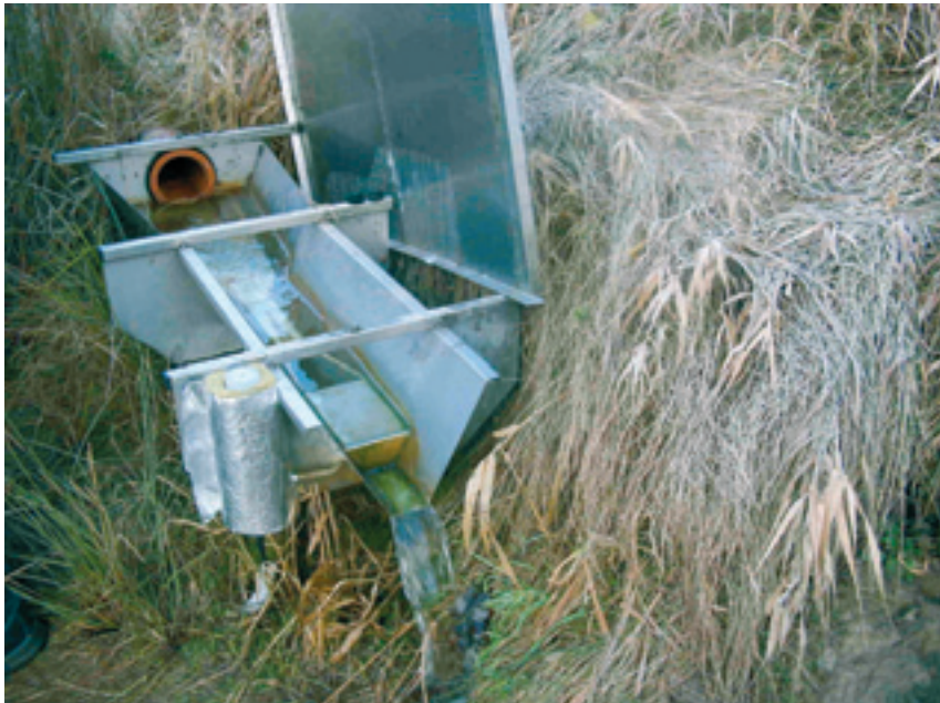
Durchflussmessung am Dränsammler (Abb. 3) Foto: Kahle
