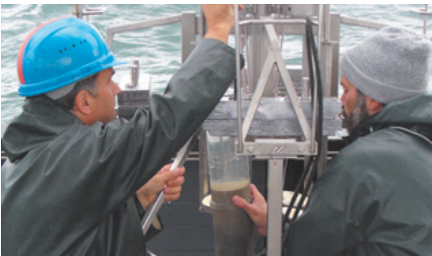
Probennahme an Bord des Forschungskutters GADUS. Stechrohre mit Sediment werden aus einem „Multicorer“ entnommen. Diese Proben mit 10 Zentimeter Durchmesser sind die typischen Einheiten, an denen der Stoffaustausch am Meeresboden untersucht wird. Foto: Peine
