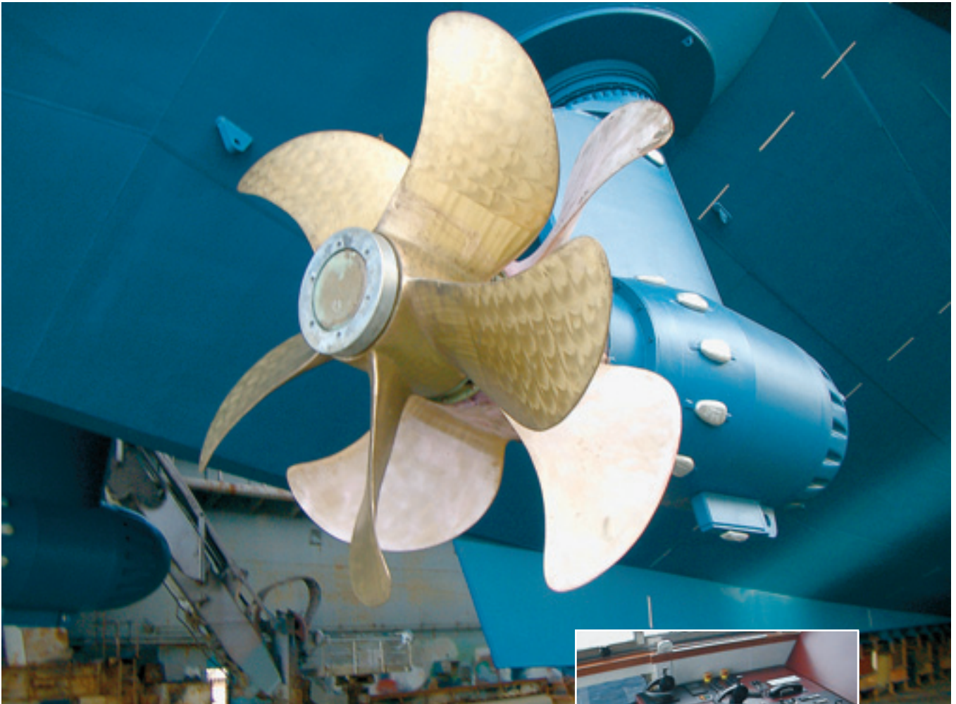
oben: Gegenläufiger Druckpropeller-Azipod der Scandlines-Fähre „Schleswig-Holstein“ (Abb. 1)
