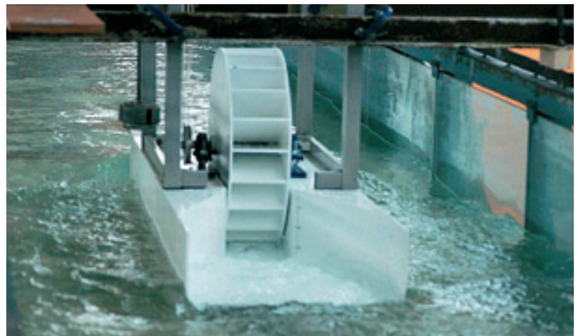
Kleinmaßstäbliches Versuchsmodell (B ~0,45 m; L ~1,40 m) (Abb. 1)
