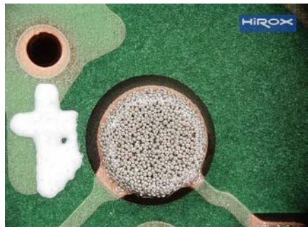
Gedruckte Lotpaste auf Leiterplat
