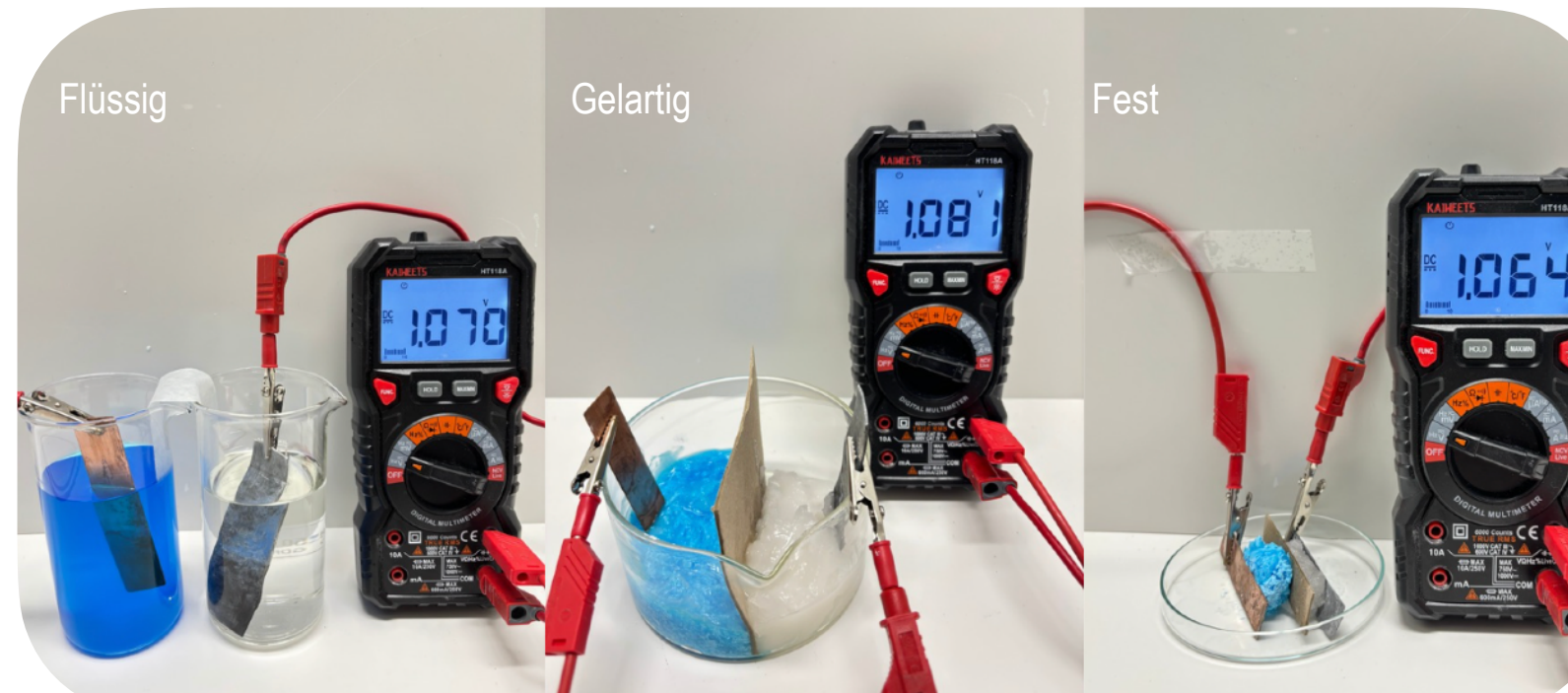
Abb. 2: Vergleich der Viskosität verschiedener Elektrolyte am Beispiel der Cu-Zn-Zelle
