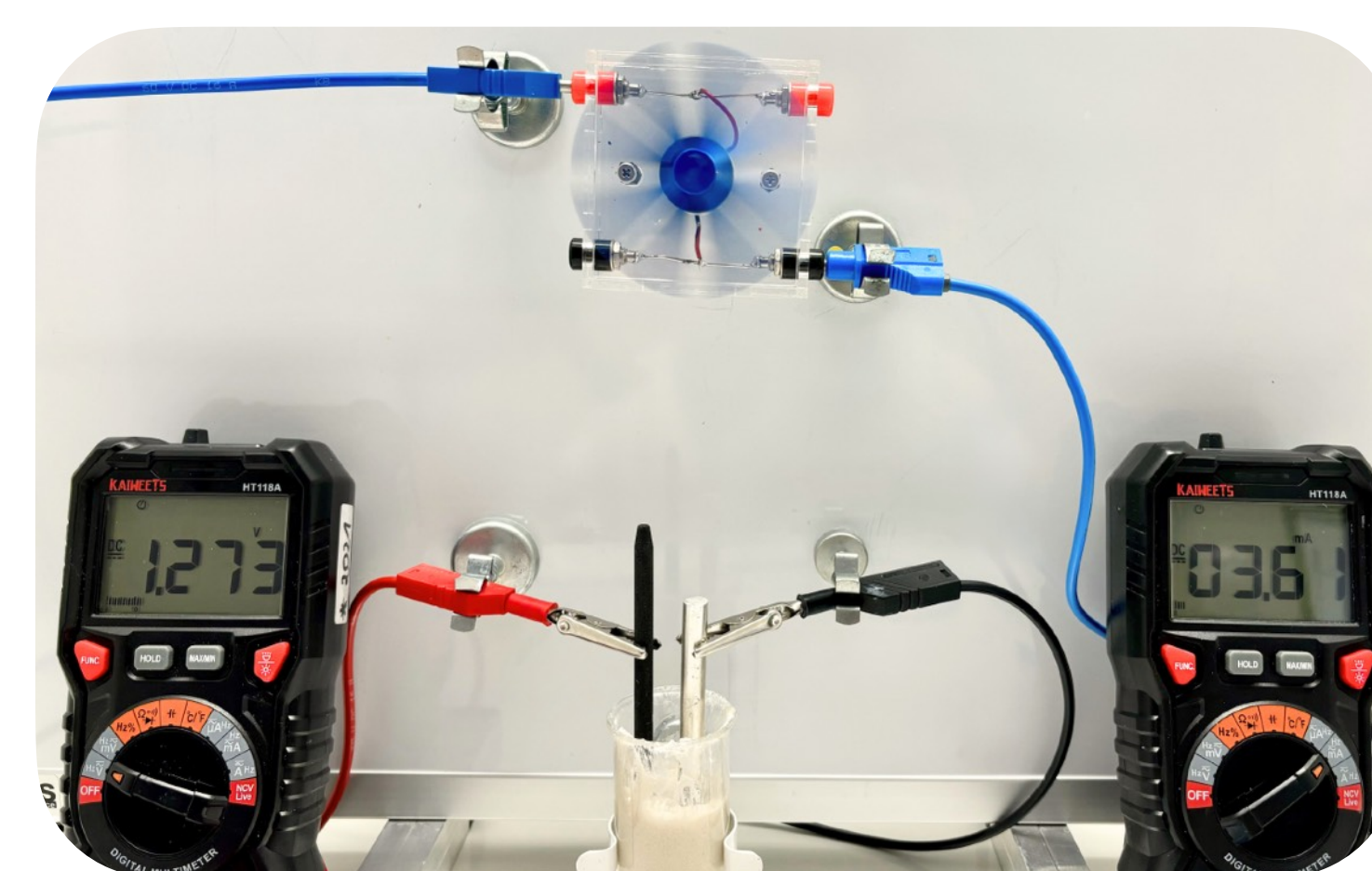
Abb. 7: Praktischer Versuchsaufbau der Magnesium-Sauerstoff-Batterie
